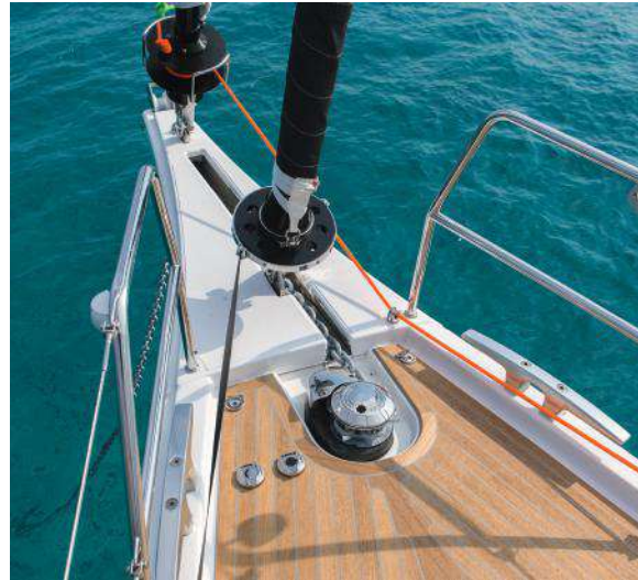
Fixed bowsprit for downwind sails mounting Delphinrière fixe pour amurage des voiles de portant
